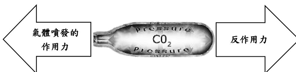
圖 4 以 CO<sub>2</sub> 鋼瓶說明牛頓第三運動定律
