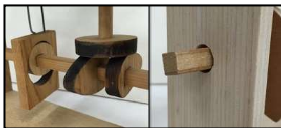
圖 15 運用方形軸之凸輪
