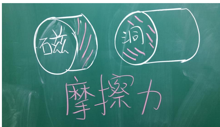
圖 2 研究者解說磁鐵側面跟孔洞內側，因接觸產生摩擦力的黑板圖。
