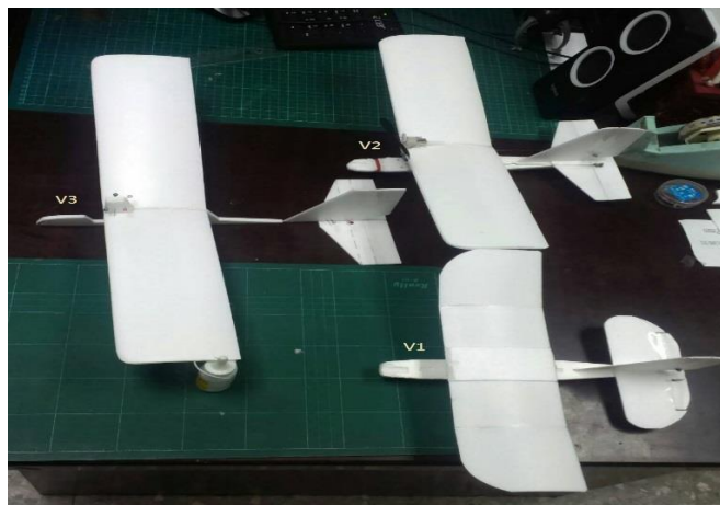
圖 2 V1 至 V3 之外型與機體結構相關之搭配
