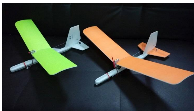
圖 4 量子一號之雙色完成機體構型。
