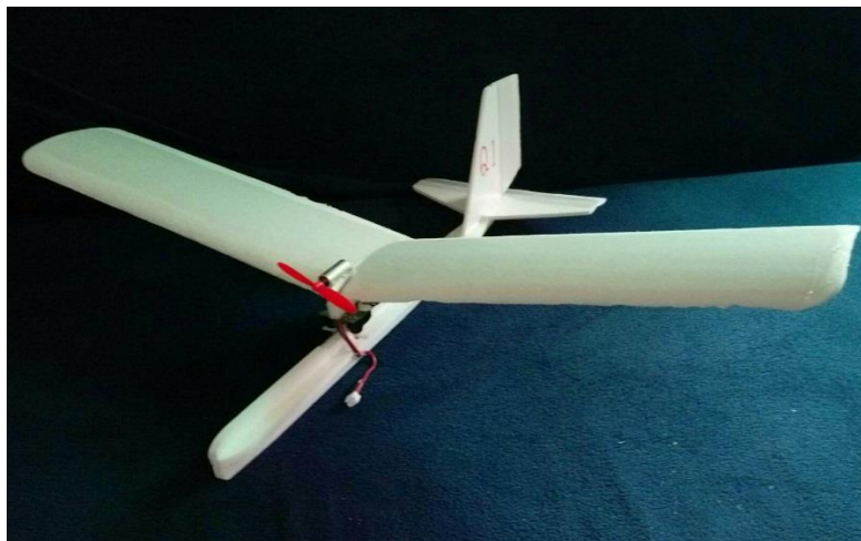
圖 1 自造超輕型室內遙控無人機之定裝照
