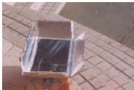
圖 5 此作品鍋蓋使用保鮮膜，然反射面面積小，許多處理上略顯粗糙
