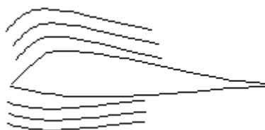
圖二、飛機飛行時機翼剖面圖。
