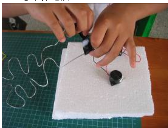
圖7 將蜂鳴器黑色蕊線(負極)與粗鐵絲一端用絕緣膠帶黏合
