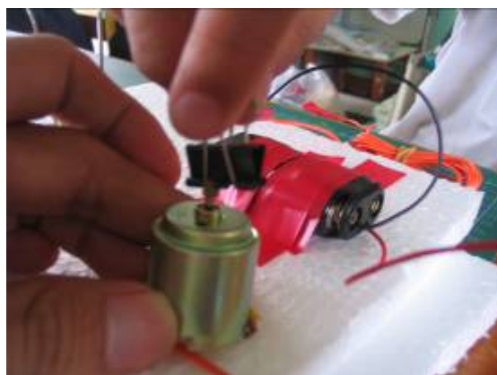
圖14 馬達端加上長尾夾增加轉動效果
