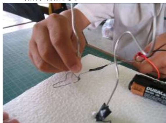
圖8 將粗鐵絲(關卡)插進入急擊棒前端造型
