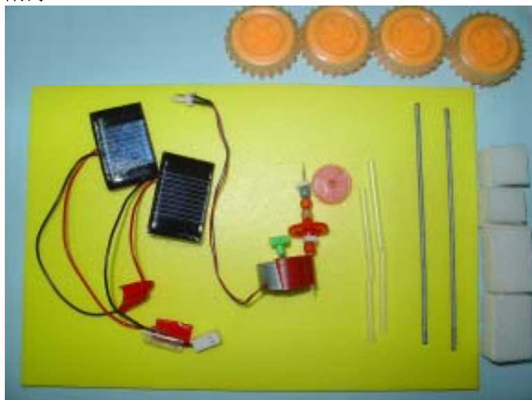
太陽能車材料包（薄珍珠版約 10×7cm、厚珍珠版約 10×1.5cm【厚約 2cm】、馬達 3.0V【已接上電線】、齒輪 3 個、串珠 5 個、鐵絲 2 根【長 15cm、直徑約 0.2cm】、細吸管 2 根、太陽能板 2 片【已接上電線】、車輪 4 個）
