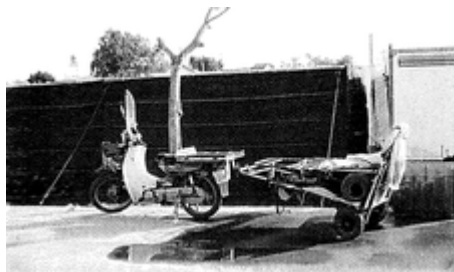
圖 19 用國民車改裝的改裝車 (圖片來源：沈默的技術－嘉南平原上的拼裝車)
