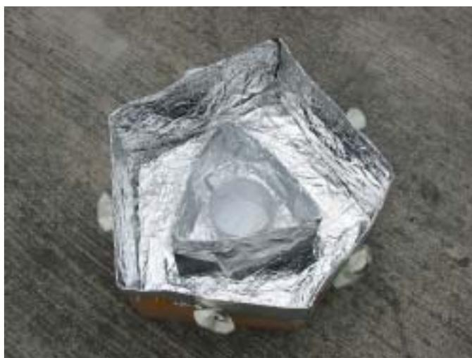
圖 9 太陽爐內塞滿鋁箔紙、外面再加上黑布保溫
