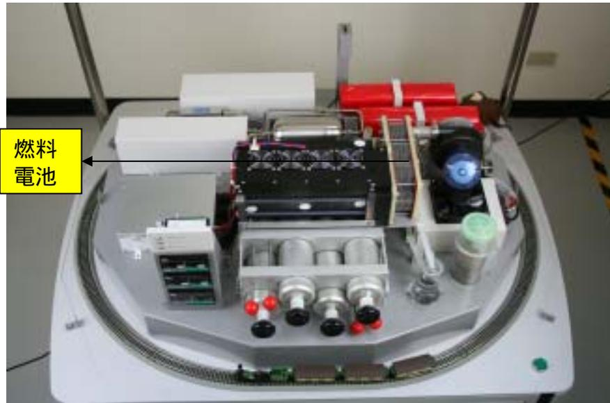
圖 7.燃料電池產電驅動小火車繞行軌道行駛之互動效果
