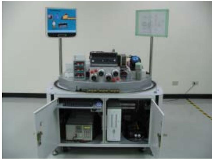
圖 2.燃料電池教具系統設備圖（2008 年完成），蕭德仁攝影
