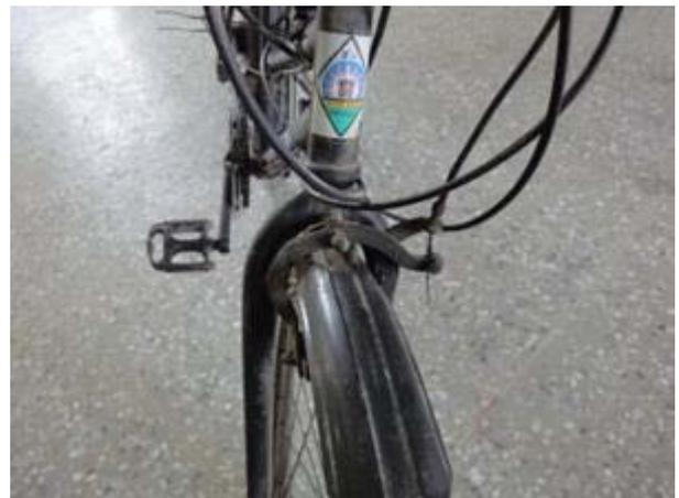
利用槓桿原理，施力點連接把手，支點固定在自行車架上，抗力點在車輪鋼框邊，抗力點的來令片（塑膠片）夾住車輪鋼框而煞車。
