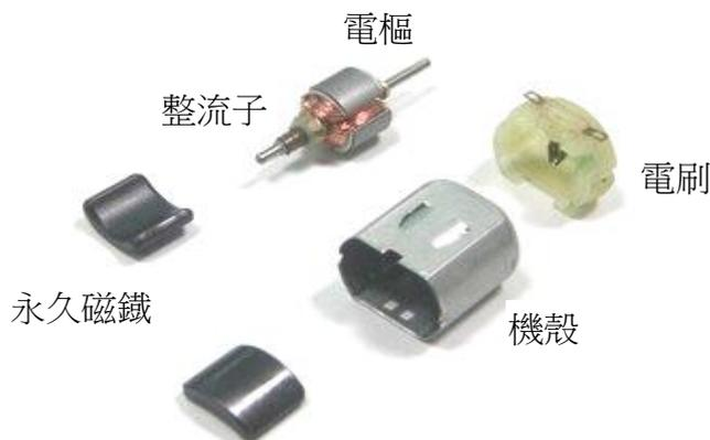
圖 8 直流電動機構造
