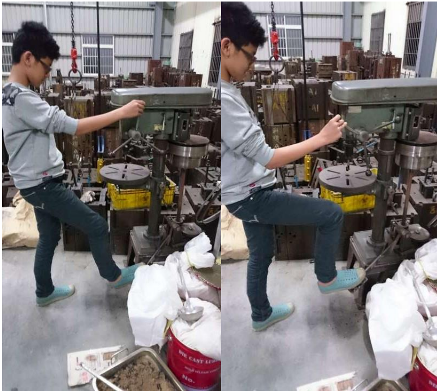
圖 13 腳踏動力鑽床操作示意
