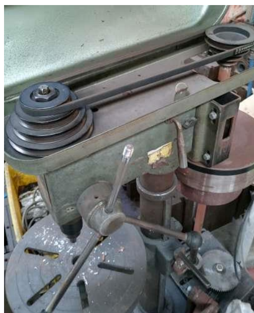
圖 16 鑽床傳動機制
