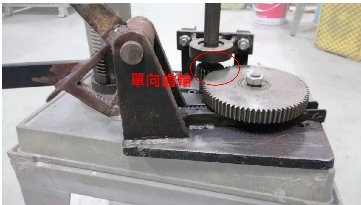
圖 11 腳踏動力鑽床傳動機構說明
