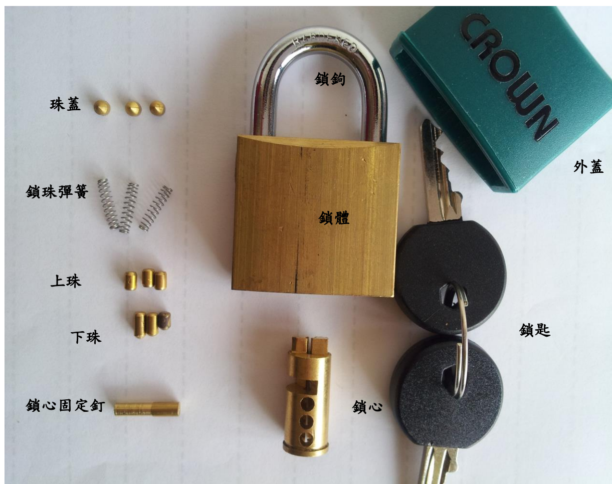
圖三 掛鎖細部零件圖
