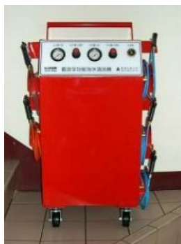
圖5 泡沫式除碳裝置（全功能式除碳裝置）
