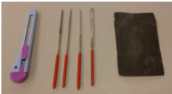
圖 12 修整船體結構材料所需之美工刀、銼刀、砂紙等手工具
