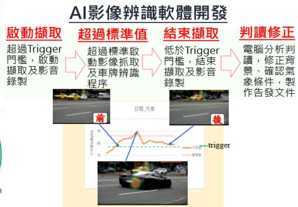
圖 4 聲音照相的辨識流程
